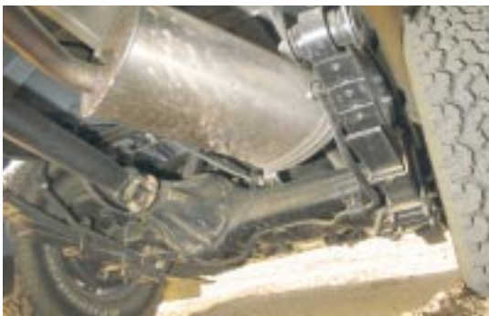
Hohe Nutzlast verlangt nach Blattfedern hinten.
